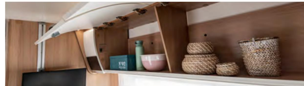
Pensili installati lasciando uno spazio dalla parete del camper, così che l'aria si distribuisce in modo uniforme e si evita la formazione di condensa o muffe.
