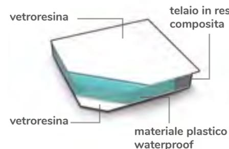
**Pavimento** di 54 mm di spessore, con rivestimento interno in PVC antiscivolo, resistente all'abrasione, costituito da una lastra in vetroresina esterna e multistrato interno, telaio in PVC e inserti di materiale plastico waterproof.
